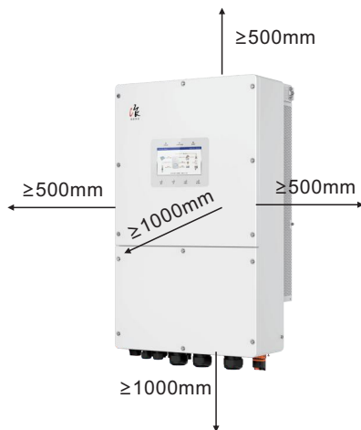
图 3.5 逆变器安装间隙
